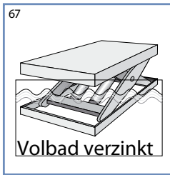
67 Heftafel volbad verzinkt, cilinder en pomp v.v. standaard coating
